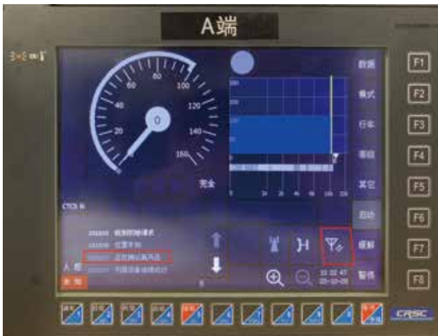
图5 电台MT2-2连接TSRS和EOT测试
