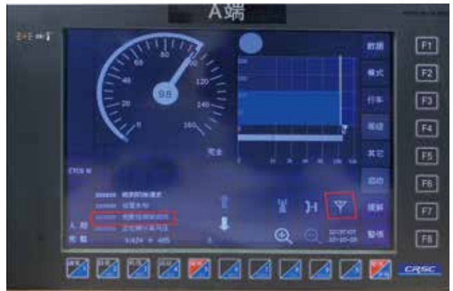
图6 电台MT2-2断开TSRS和连接EOT测试
