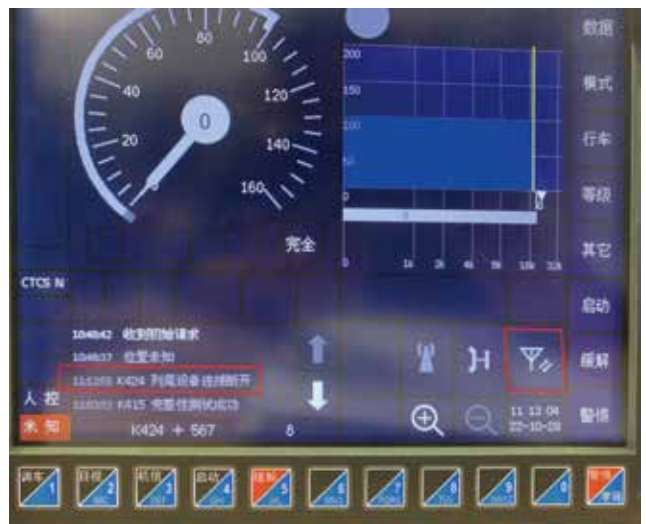
图7 电台MT2-2连接TSRS和断开EOT测试
