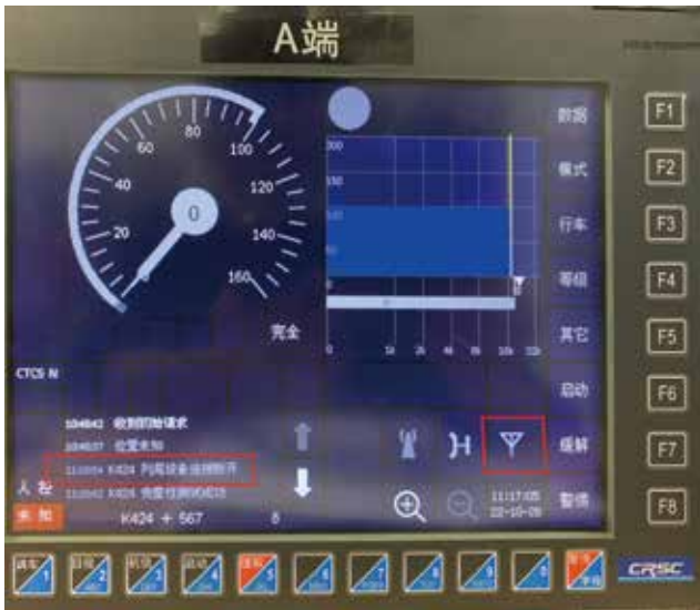
图8 电台MT2-2断开TSRS和EOT测试
