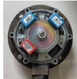
图1 哈斯勒车载测速电机的结构 Fig.1 Structure of Hasler odometer
