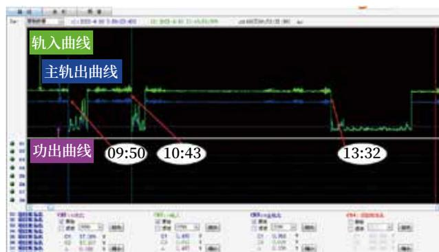
图1 室内功出、轨入、主轨出电压曲线
