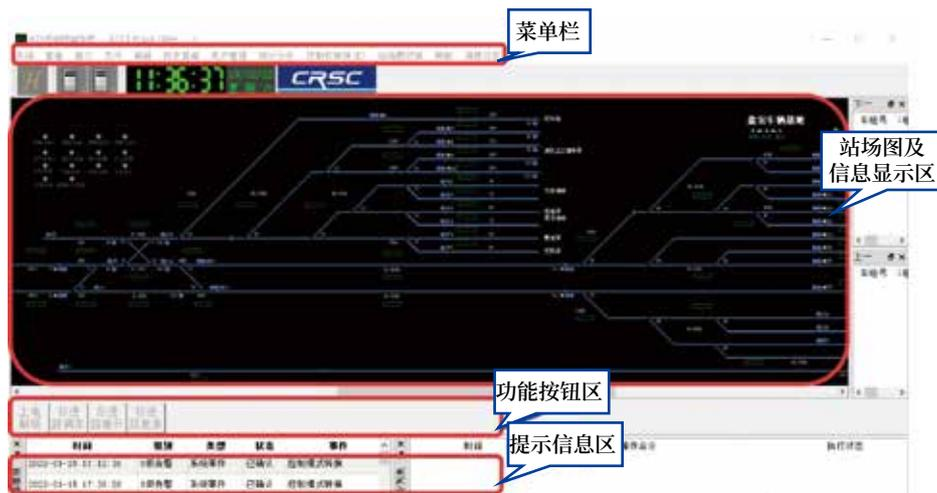
图3 车辆段CBTC系统ATS中心调度工作站界面
