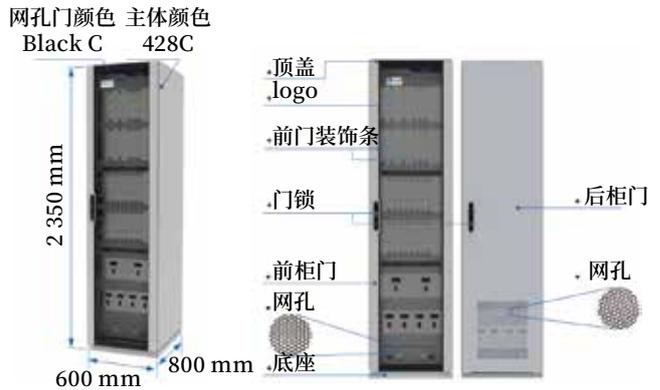
图1 铁路信号用机柜尺寸、颜色、布局
