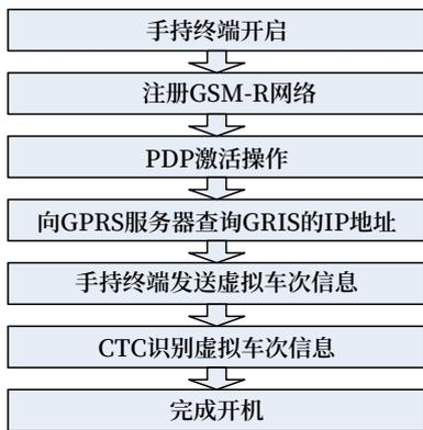
图2 外勤终端启动流程
