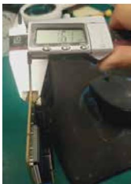
图4 MOXA CP-134U-I型串口卡PCB板厚度
