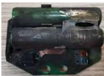
图1 道岔整流二极管损坏
