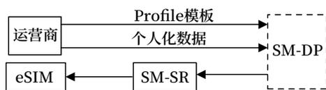
图1 eSIM数据远程下载流程
