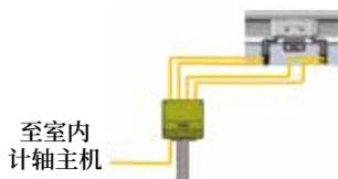
图2 磁头传感器与轨旁电子单元连接示意图
