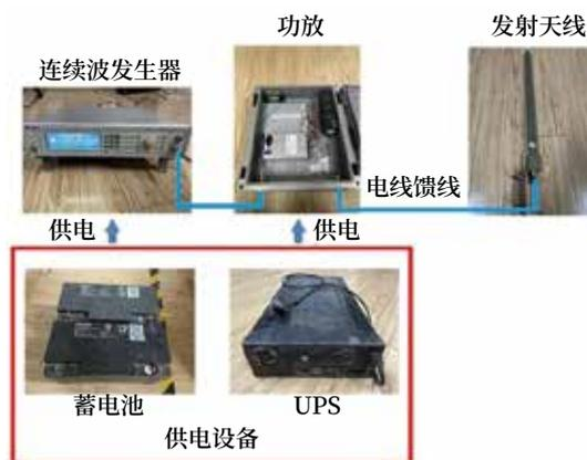
图3 连续波测试实验设备连接
