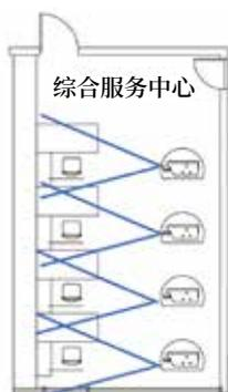
图2 点状场景视频监控终端设备布点示意
