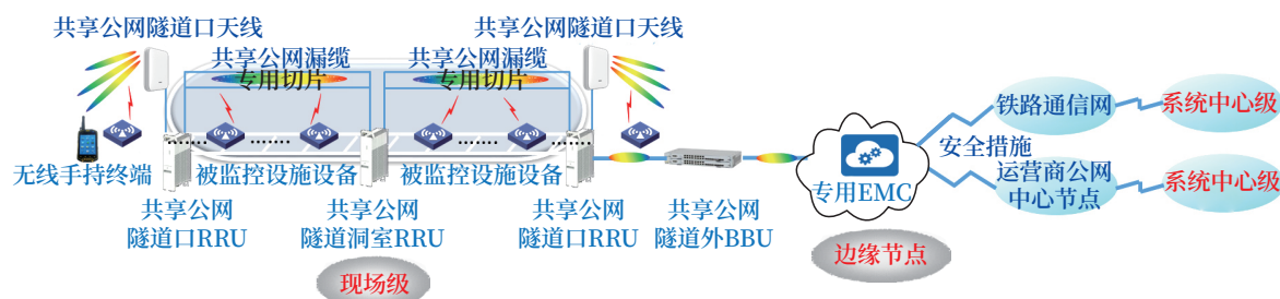
图4 基于铁路5G公网的新型铁路隧道防灾疏散救援监控系统部署方案拓扑
